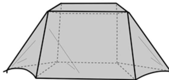
フライシートを広げ、インナーテントの張り具合に合わせて図のようにインナーテントを被せていきます。
