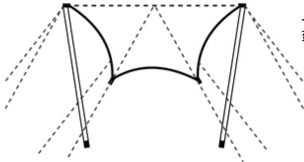
サブロープをタープの中心の延長線上にペグダウンします。
