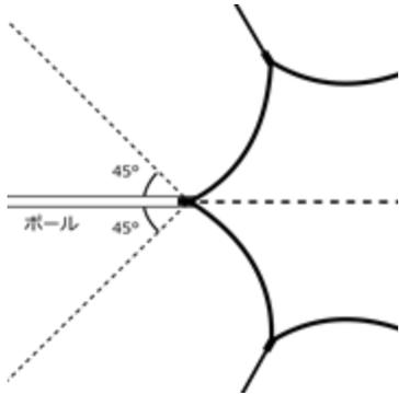
タープ本体を地面に広げ、ポールの先端をタープのグロメットに差し込み、2本のポールを立ち上げます。
